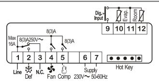
BEM.: Spannungsversorgung ist abhängig vom Modell 120Vac.
