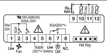
BEM.: Verdichter-Relais ist abhängig vom Modell 20(8)A oder 16(6). BEM.: Spannungsversorgung ist abhängig vom Modell 120Vac.
